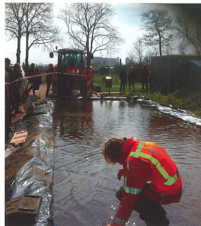
Tijdens een workshop is een deel van een straat in Groningen blank gezet om de doorlatendheid van de verharding te meten.
